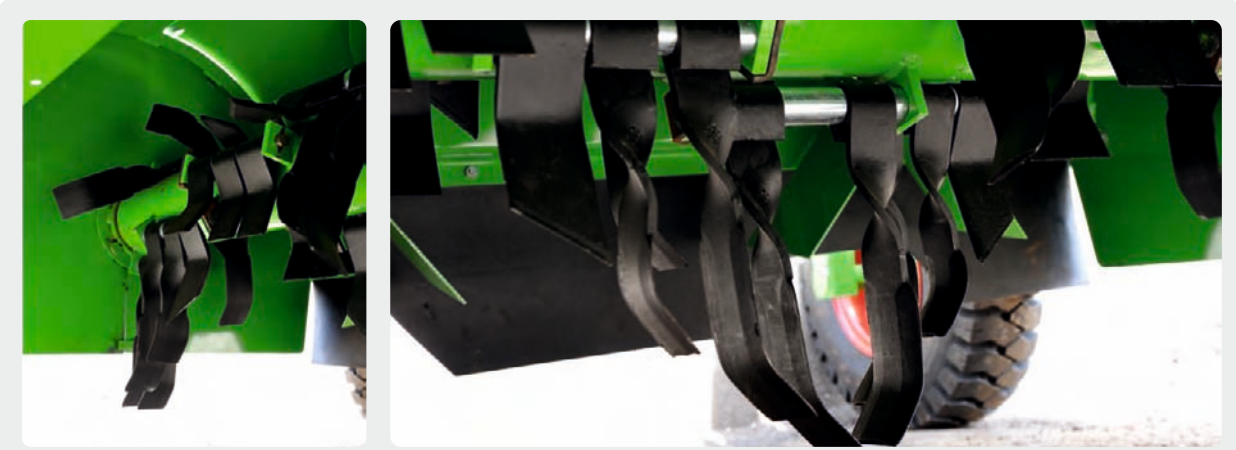
■ Износостойкие бичи, копирующие форму гребня
