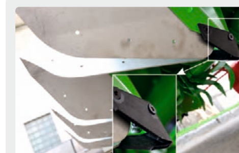
■ Сменные пластины формирователя гребня
