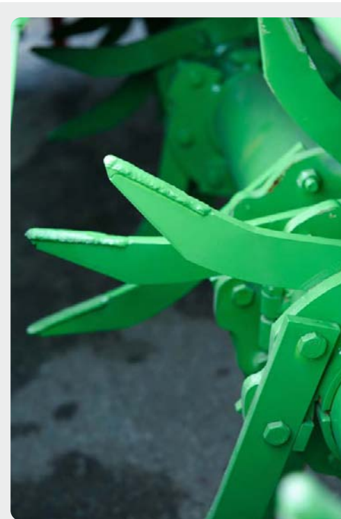
■ Высокопрочные зубья для каменистой почвы
