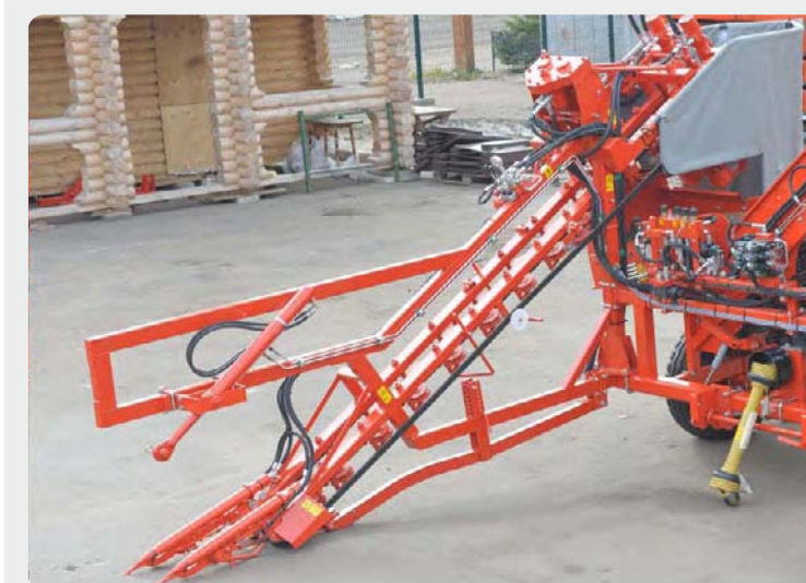
■ Уборочный элемент с теребильными ремнями
